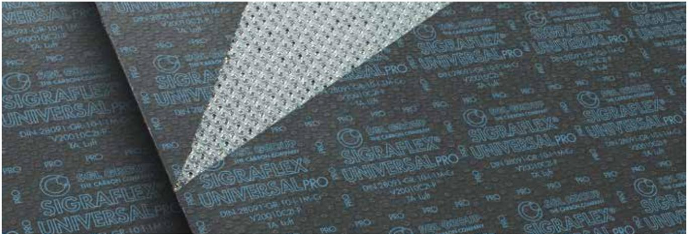
SIGRAFLEX UNIVERSAL PRO ist eine kleberfreie Graphitdichtungsplatte, bestehend aus flexibler Graphitfolie und verstärkt durch eine bzw. zwei Spießblecheinlagen aus Edelstahl 316 (L).
