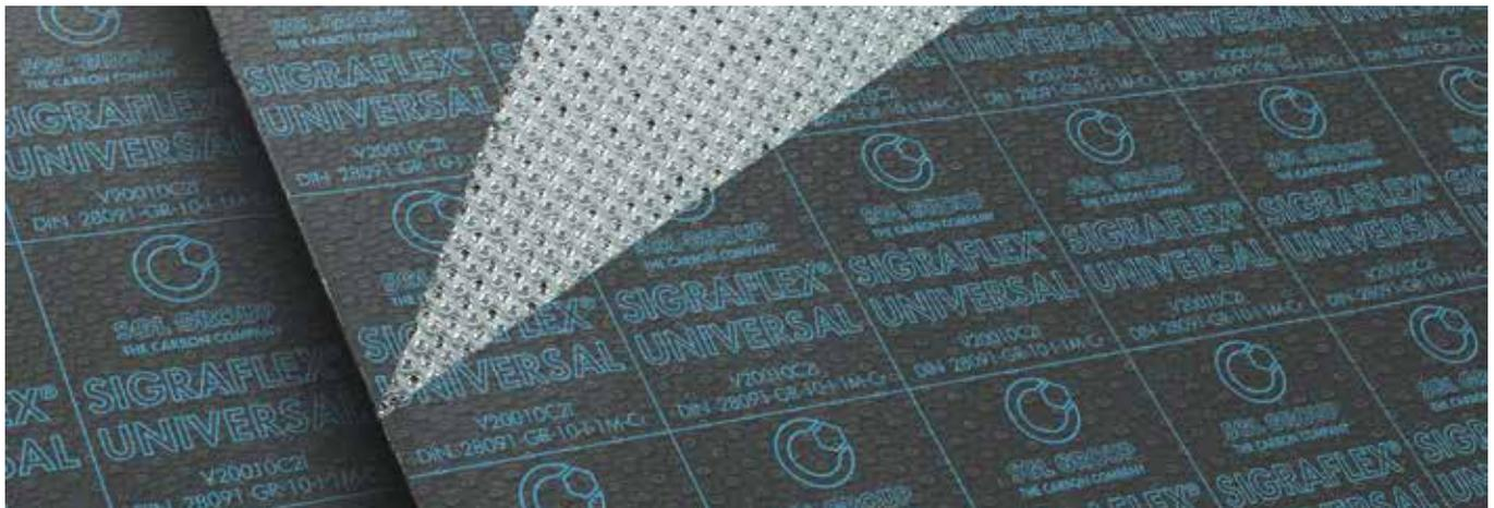
SIGRAFLEX UNIVERSAL ist eine kleberfreie Graphitdichtungsplatte aus flexibler Graphitfolie und verstärkt durch eine bzw. zwei Spießblecheinlagen aus Edelstahl 316 (L).
